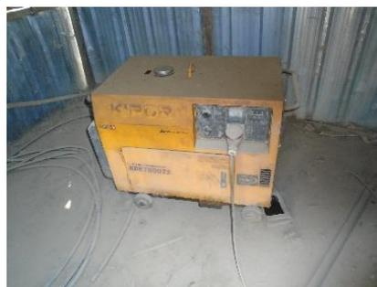
Photo 13 : groupe électrogène utilisé par le délégataire résilié pour alimenter la Mini-AEP multi-village d'Angoual Gourey, Yaouri
